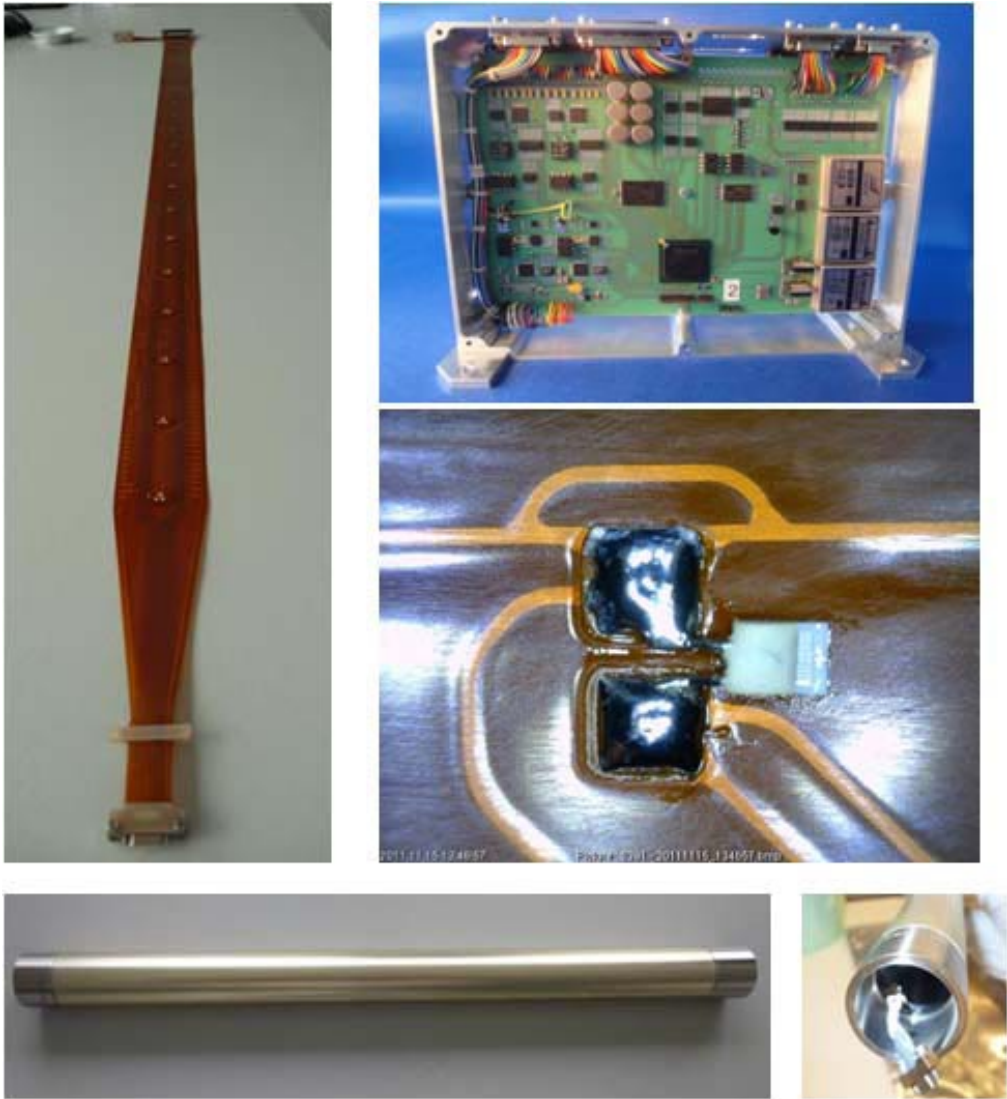
рис. 7. Верхний левый: каптоновая шина с датчиками; 14 датчиков PT100 расположены через 35 см. Верхний правый: базовая электроника зонда для измерения теплового потока в миссии InSight, использовавшаяся для управления активными нагревателями и пассивными датчиками. Центр справа: увеличенное изображение тонкоплёночных сенсоров PT100, установленных на шине. Нижний левый: зонд для измерения теплового потока в миссии InSight, интегрированный в корпус пенетратора. Нижний правый: электрическое соединение нагревателей внутри корпуса пенетратора
