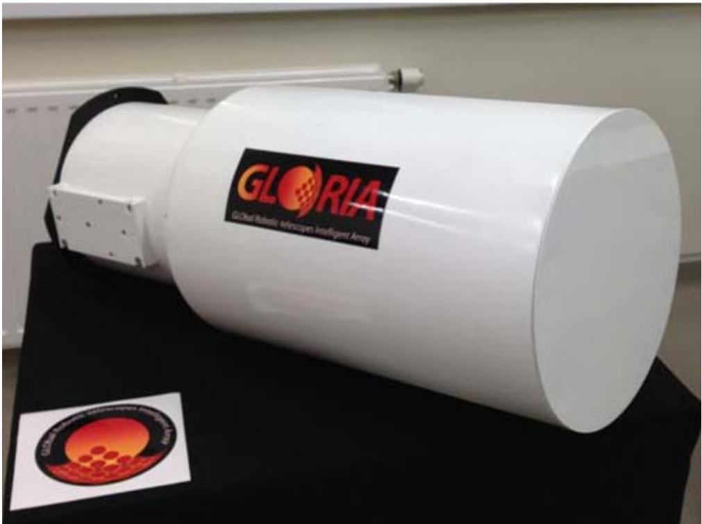
рис. 2. Объектив VT-78 в сборе с блендой.
