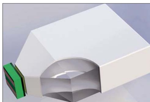
Рис. 4. Сцинтилляционный детектор на основе паратерфенила и кремниевого ФЭУ лабораторного образца прибора SIDRA
