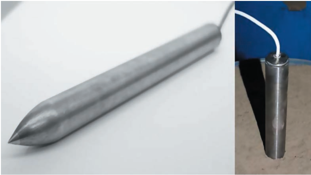
рис. 6. Пенетратор EMOLE (слева), этот пенетратор во время теста (справа).
