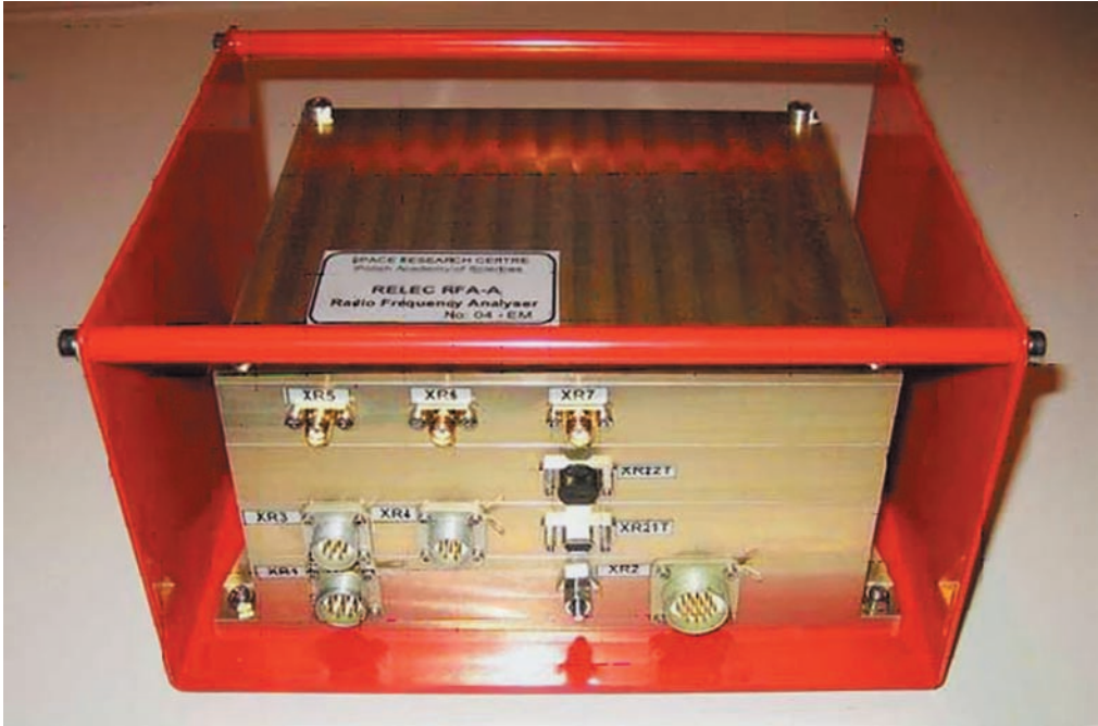
рис. 11. Блок анализатора РЧА-А. rys. 11. Blok analizatora RFA-A.
