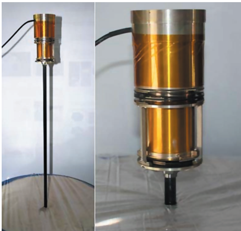
рис. 5. Начальное положение НЕЕР-пенетратора в кварцевом песке ( слева ), после заглубления ( справа ).
